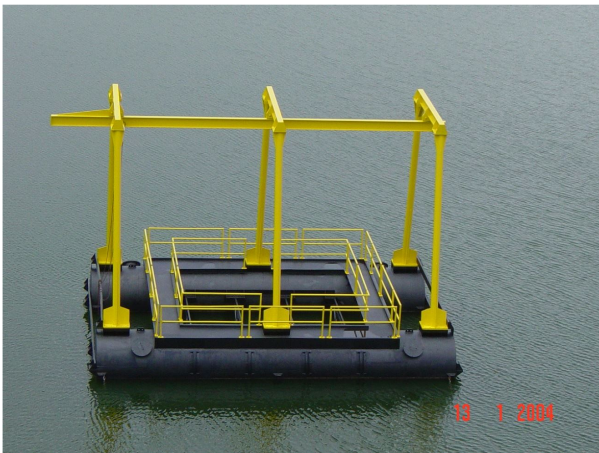
Figura 3 – Flutuante para captação de água no açude Jucazinho
